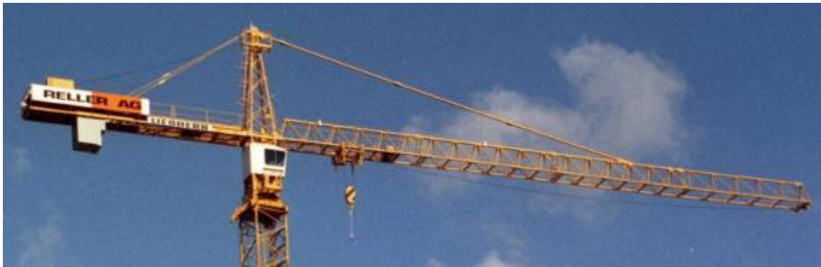
Einfache Zugstangenabspannung des Auslegers auf den Obergurt. Die Zugstange wird bei der Montage mit der kraneigenen Hubwinde zur Turmsitze hochgezogen, wozu der Ausleger nur leicht überzogen werden muss.
