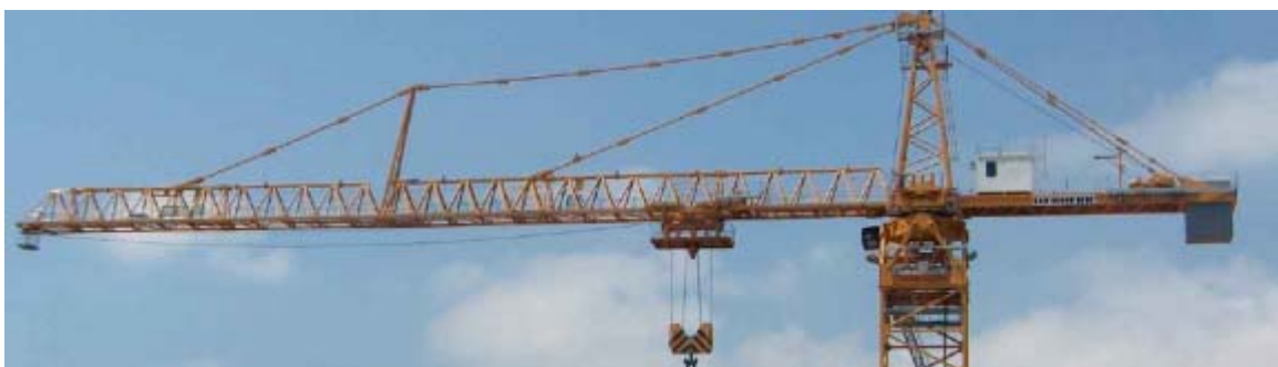
Doppelte Auslegerabspannung mit Zwischenbock (A - Bock) und geteiltem Ausleger bei einem Liebherr Grosskran Form 3150 HC. Durch diese Bauweise kann auch ein doppelt abgespannter Ausleger zweiteilig montiert werden, was bei grossen Kranen unbedingt notwendig ist.
