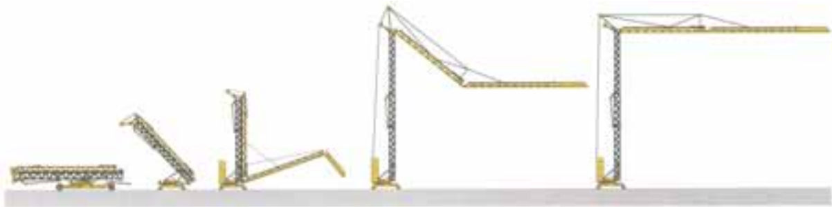
Abbildung 2-28: Montageablauf Schnellaufsteller [Zep-96]
